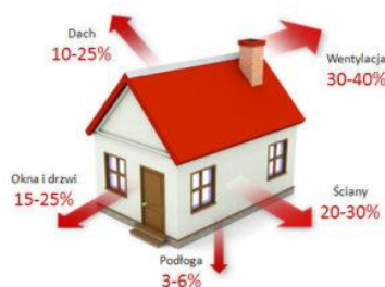
Rysunek 19. Procentowa strata ciepła w budynku 11
